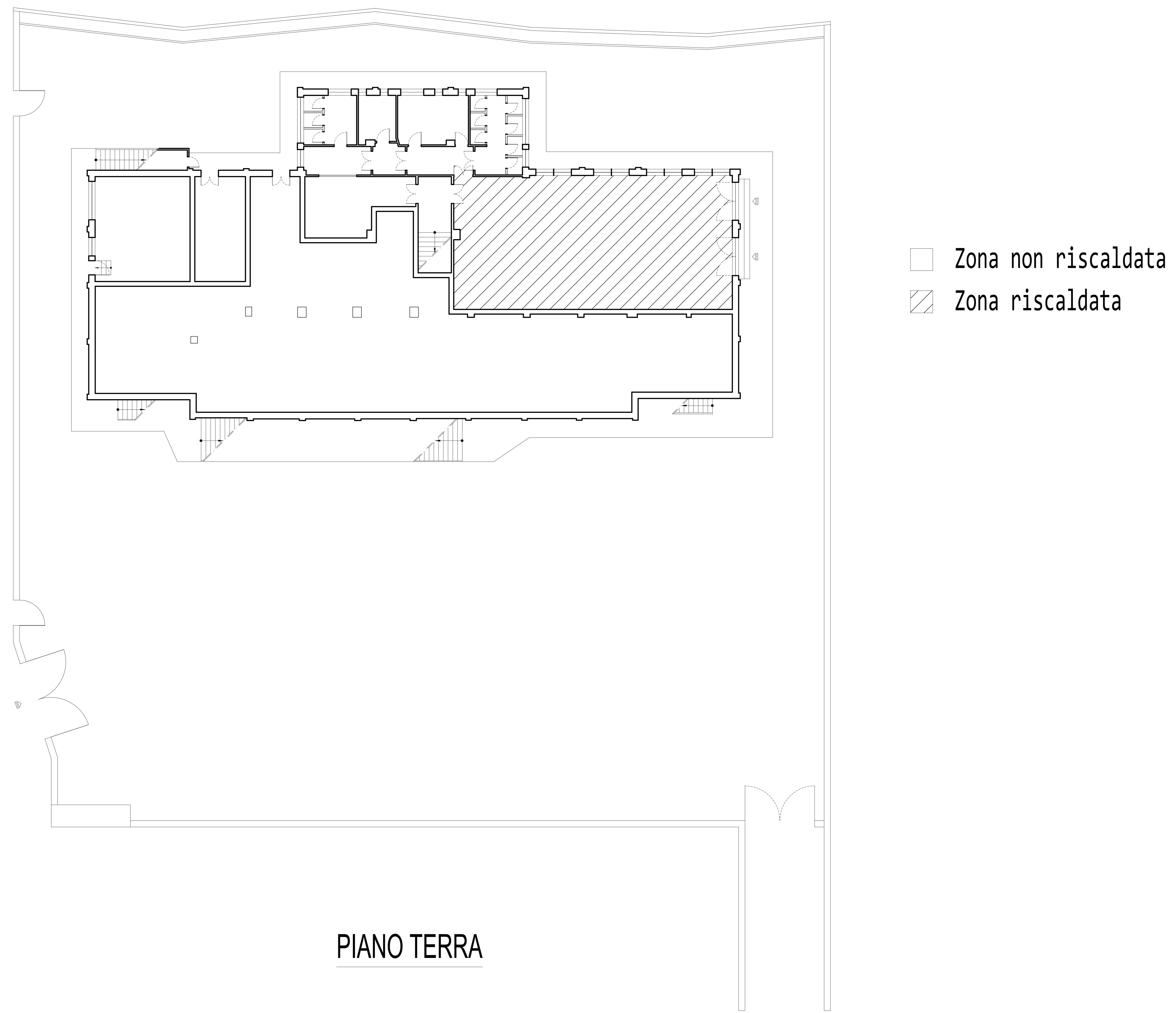
Planimetrie con individuazione delle diverse zone termiche, degli spazi riscaldati e non riscaldati e delle diverse destinazioni d'uso
