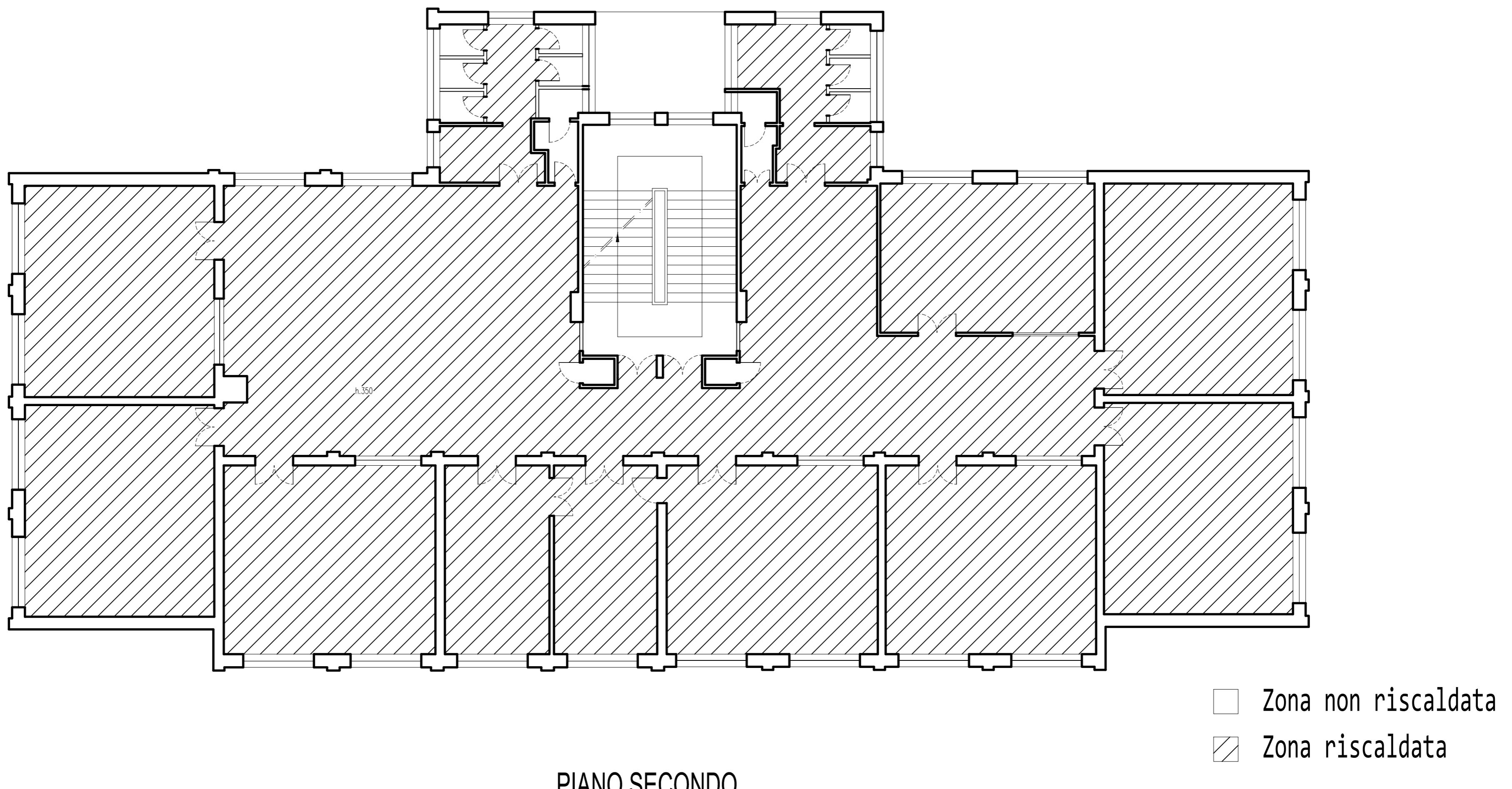
Planimetrie con individuazione delle diverse zone termiche, degli spazi riscaldati e non riscaldati e delle diverse destinazioni d'uso
